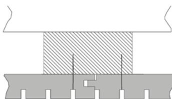
**Klammern in Sichtnut von NUTFORM LAMELLEN** können mit speziellen Klammernaglern verwendet werden, welche leihweise bei TRIKUSTIK bezogen werden können.
