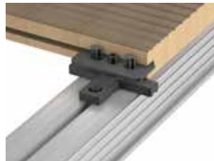
Universalclip Pro für Holz / WPC mit Holz- oder Aluschraube Plattenhöhe 6 mm
