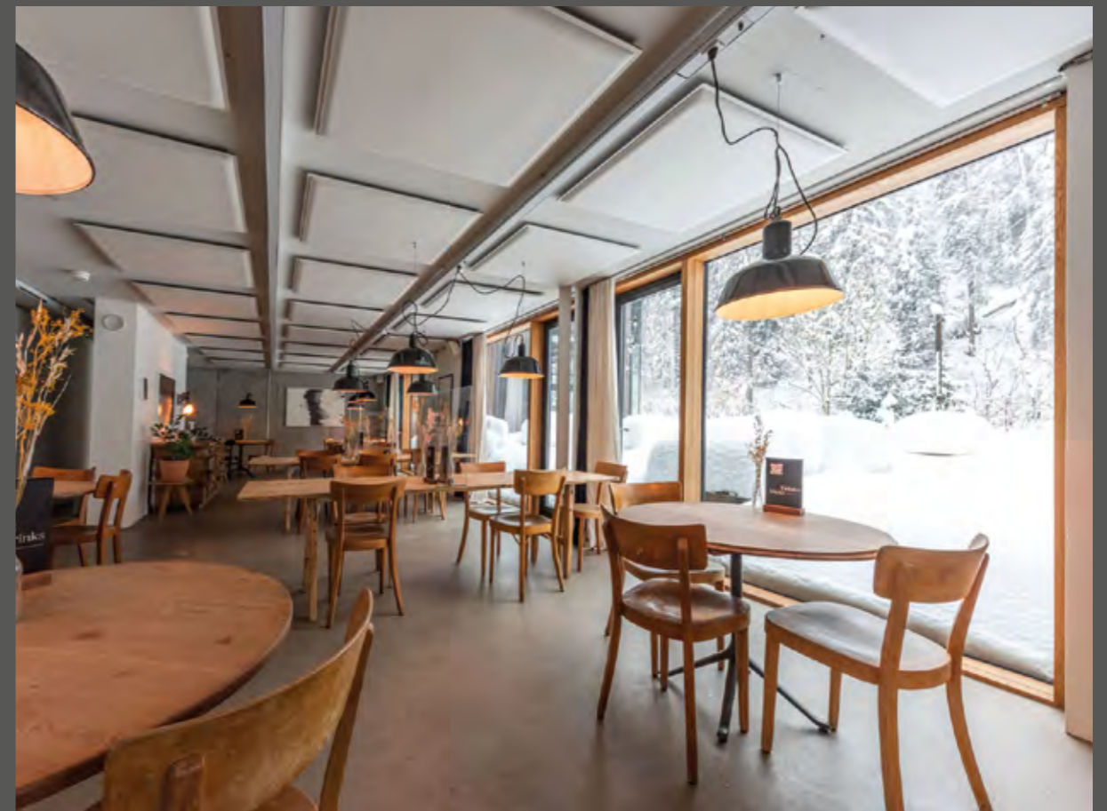
oben: WOOPIES LIGHT Deckensegel-Installation mit Seilsystem. Objekt: Grünenfelder und Partner AG, Domat / Ems unten: WOOPIES Deckeninstallation mit Magneten. Objekt: Riders Hotel, Laax
