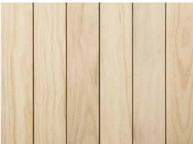
Dauerhaftes und formstabiles acetyliertes Kiefernholz aus schnell wachsenden und hauptsächlich nachhaltig beforsteten Wäldern. Hohe Widerstandsfähigkeit gegen holzerstörende Pilze und Insekten. Verbindungsmittel, Auflager und Unterkonstruktionen zwingend in Edelstahl A2 oder Accoya verwenden. Andere Produkte, insbesondere Metalle, führen zu Oxidationen, welche sichtbare Verfärbungen auf der Oberfläche hervorrufen.
