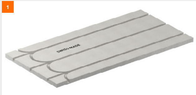
fermacell® Therm25™ Standard-Platte mit Fräsungen für die Längsverlegung mit Umlenk-Nuten, Nutabstand 167 mm.
