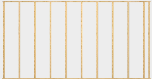
Achsabstand Unterkonstruktion max. 500 mm
